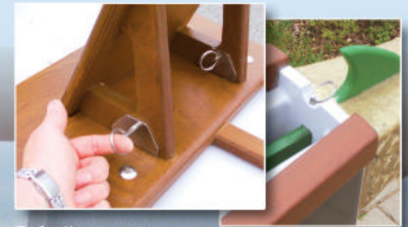
Befestigung von Trommlerstuhl, Schwanz und Kopf mit Kugelsperrbolzen (schnell und sicher)
